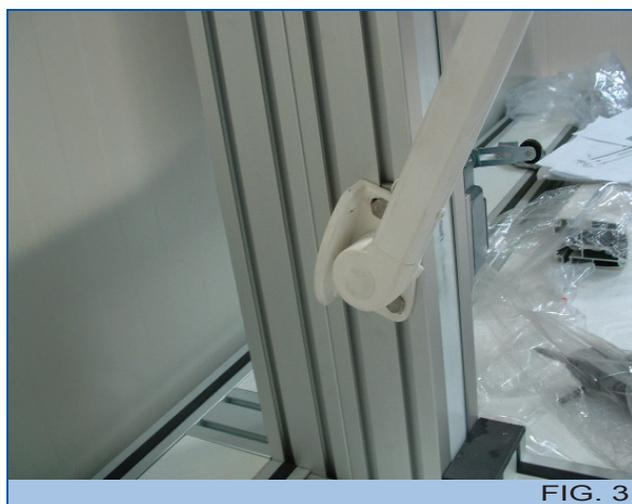
3º Fijar la placa del brazo en la superficie de apoyo (Fig. 3).
